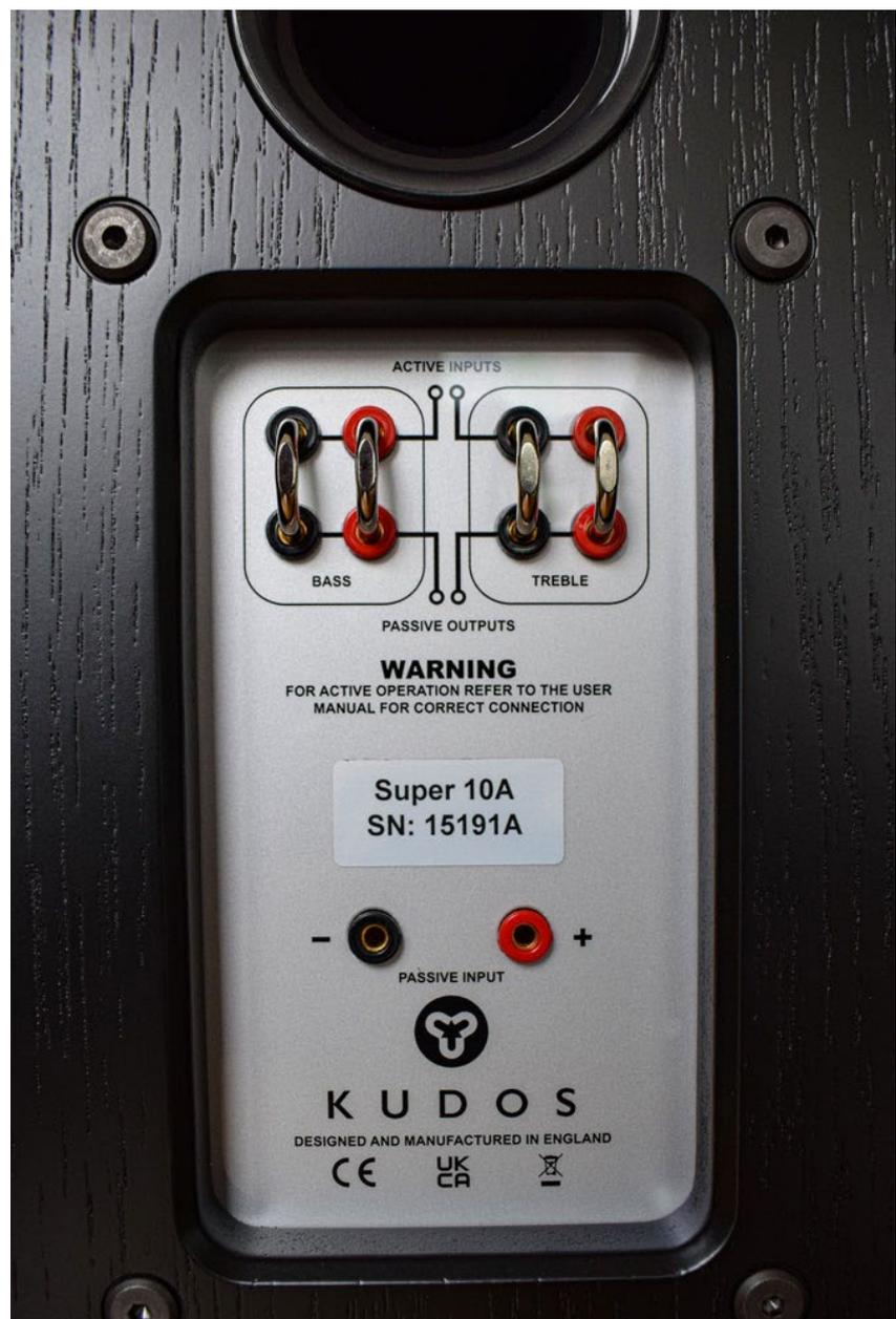
Das Anschlussfeld ist für die Aktivierung vorbereitet. Neben der etwas besseren Bauteilqualität ist dies der größte Unterschied zur ansonsten fast baugleichen C10 (Foto: H. Biermann)
