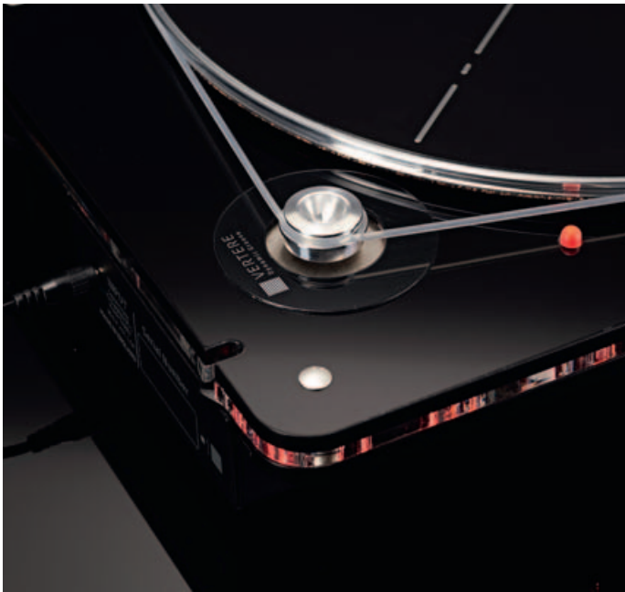
Zur Achse hin fest eingespannt, tangential zum Teller dagegen leicht beweglich: der Pulley des 24-poligen Synchronmotors.
