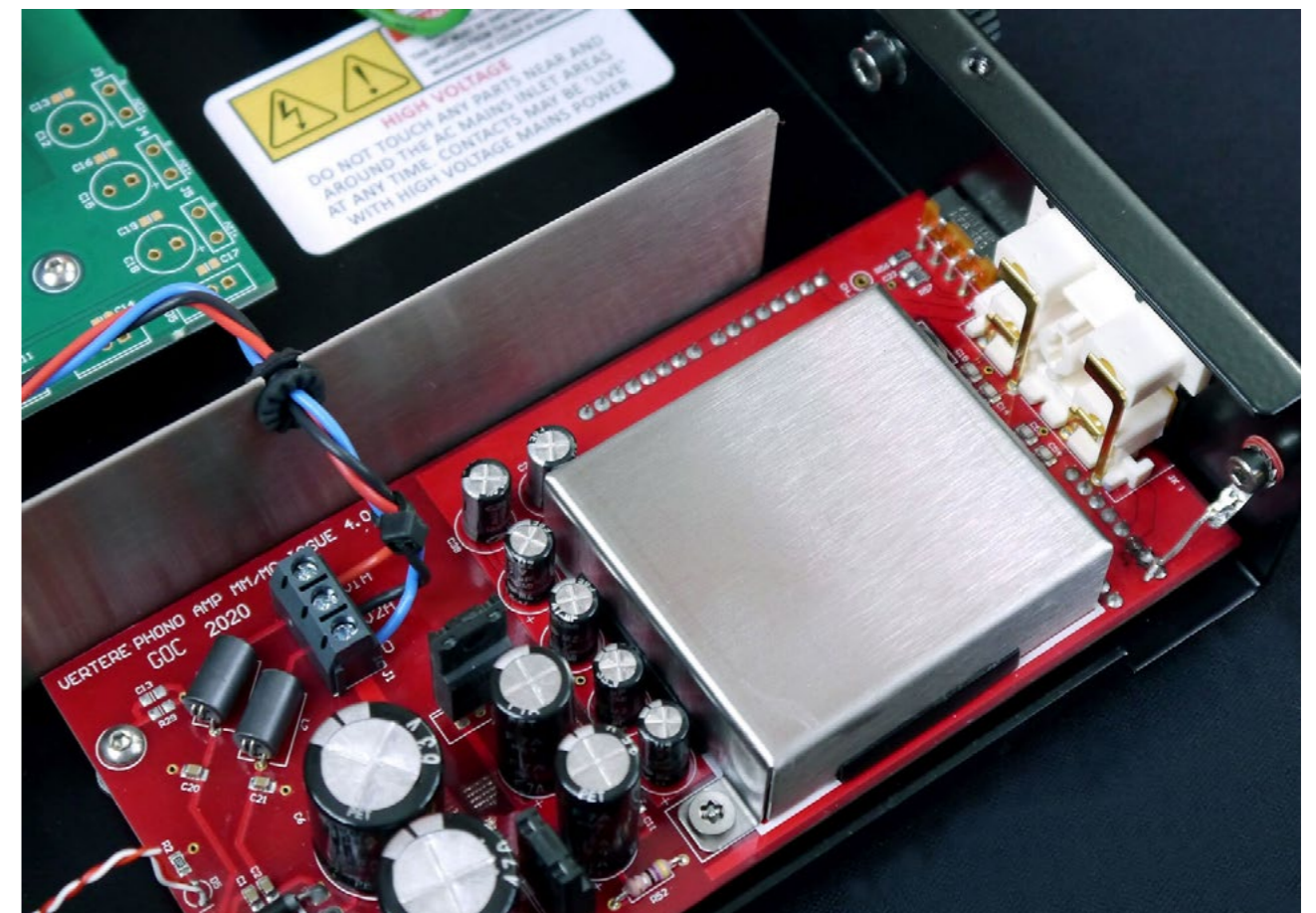
Die eigentliche Verstärkungs-Platine ist von dem Blechkasten vorn gegen Einstreuungen geschützt
