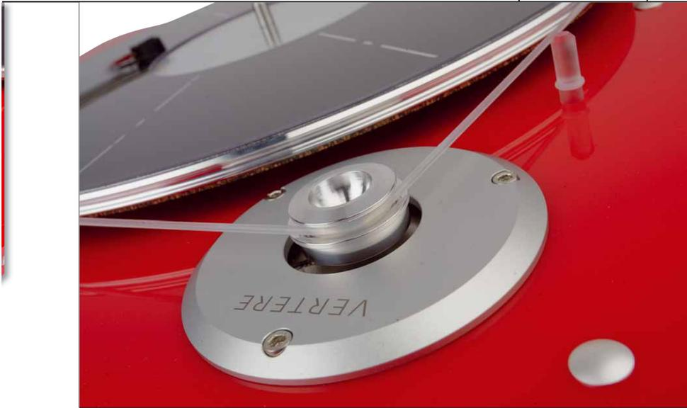
*Fest mit der Zarge verbundene Motoreinheit, deren Pulley aber schwingend gelagert ist und sich unter Strom durch den dicken Riemen selbst zentriert*
